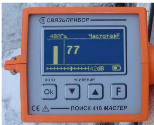
Если необходимо более точно исследовать сигнал, включают режим «Чужой генератор» и выбирают нужную частоту. В нашем случае это 480 Гц. Прибор показывает уровень сигнала на выбранной частоте.
