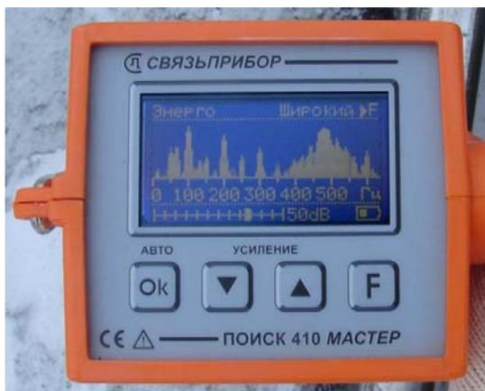
На экране видны пики на частотах рельсового тока 50 Гц с гармониками и сигнал от стандартной тоновой частоты 480 Гц. В головных телефонах прослушиваются периодические сигналы.
