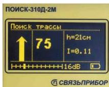
Подключите индуктивный определитель к приемнику. Расположите определитель над искомым кабелем для поиска «по максимуму», как показано выше. Выберите режим «Поиск трассы». Дождитесь окончания автонастройки прибора. Нажав кнопку **F**, зафиксируйте направление.
