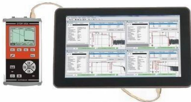
Программа Visa Viewer X-PRO может управлять оптическими рефлектометрами VISA как с платформы X-PRO, так и с любого компьютера с ОС семейства Windows.
