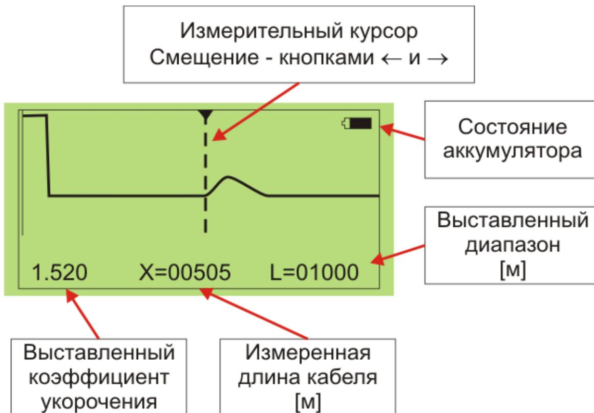
Измерение заключается в позиционировании измерительного курсора на начало эхо сигнала от конца кабеля. Для более точного позиционирования можно изменять усиление и растяжку в параметрах. Более подробная методика определения длины приведена в Руководстве по эксплуатации прибора.
