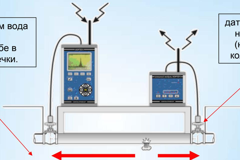
Шум от утечки принимается датчиками, сигналы с датчиков пересылаются по радиоканалу и сравниваются. Фильтры очищают полезный сигнал от шумов. Сравнение сигналов позволяет точно локализовать место утечки жидкости в напорных трубопроводах (вода, теплоноситель, нефтепродукты и др.); несанкционированные подключения и врезки – независимо от глубины прокладки, вида грунта, интенсивности шума среды.
