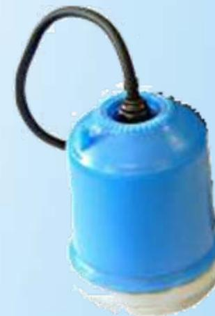
Акустический локатор фиксирует звуковой сигнал на поверхности земли. Фильтры выделяют шум утечки и отстраиваются от помех. Визуализация спектра звукового сигнала делает прибор адаптированным для людей без абсолютного музыкального слуха.
