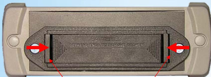
Нажав на фиксаторы, легко извлечь батарейный отсек
