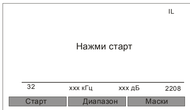
Рис. 9-16 Экран режима измерения рабочего затухания
