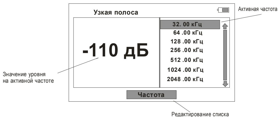
Рисунок 9-12. Экран режима узкополосного измерения уровня
