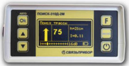
Проверку отбора производят в режиме генератора **«ВЧ»** или **«ВЧ-ПАУЗА»** (2 187,5 Гц), переключив приемник в режим **«ПОИСК ТРАССЫ»**. Далее необходимо зафиксировать направление сигнала на отобранном кабеле кнопкой **«F»**. При переключении отборника на любой соседний кабель сигнал меняет направление на обратное и величина сигнала уменьшается.
