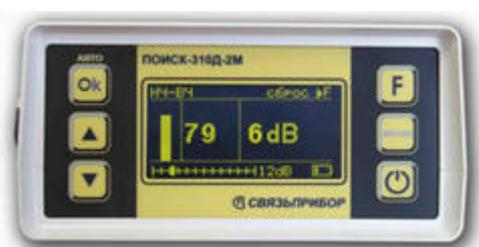
Сигнал «своего» кабеля отличается от соседних по величине и направлению. Чтобы уменьшить ток в соседних кабелях, используют низкую частоту генератора 273,5 Гц в режиме «НЧ-ВЧ». Клещи-отборник уверенно слышат этот сигнал и отбирает «свой» кабель по величине сигнала в режиме приемника «НЧ-ВЧ».
