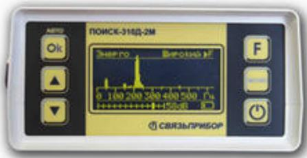
Отбор кабеля под нагрузкой проводят в режиме **«СПЕКТР»**. Если это силовой кабель, следует установить режим **«Энерго»**. Токи в трехфазном кабеле должны быть скомпенсированы. Однако часть электромагнитного поля все же выходит из кабеля и фиксируется приемником по характерным гармоникам промышленной частоты (50-100-150...Гц).
