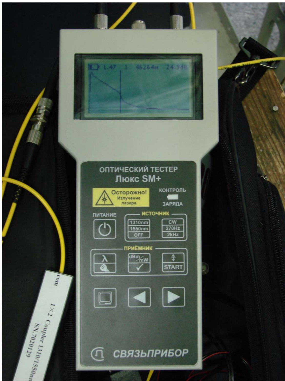
Рис. 2. Измерения на линии длиной 93 км с неисправным участком кабеля.
