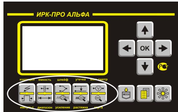
Навигационные кнопки  $\blacktriangle \nabla \leftarrow \rightarrow$  и [OK]. Навигационные кнопки перемещают по экрану, кнопка [OK] запускает выбранный пункт.
