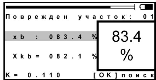
Внимание! На экран выводится результат X<sub>k</sub> с поправочным коэффициентом для симметричных кабелей связи. Результат появляется, если в режиме ИЗОЛЯЦИЯ измерен коэффициент K. Для силовых кабелей этого не требуется.
