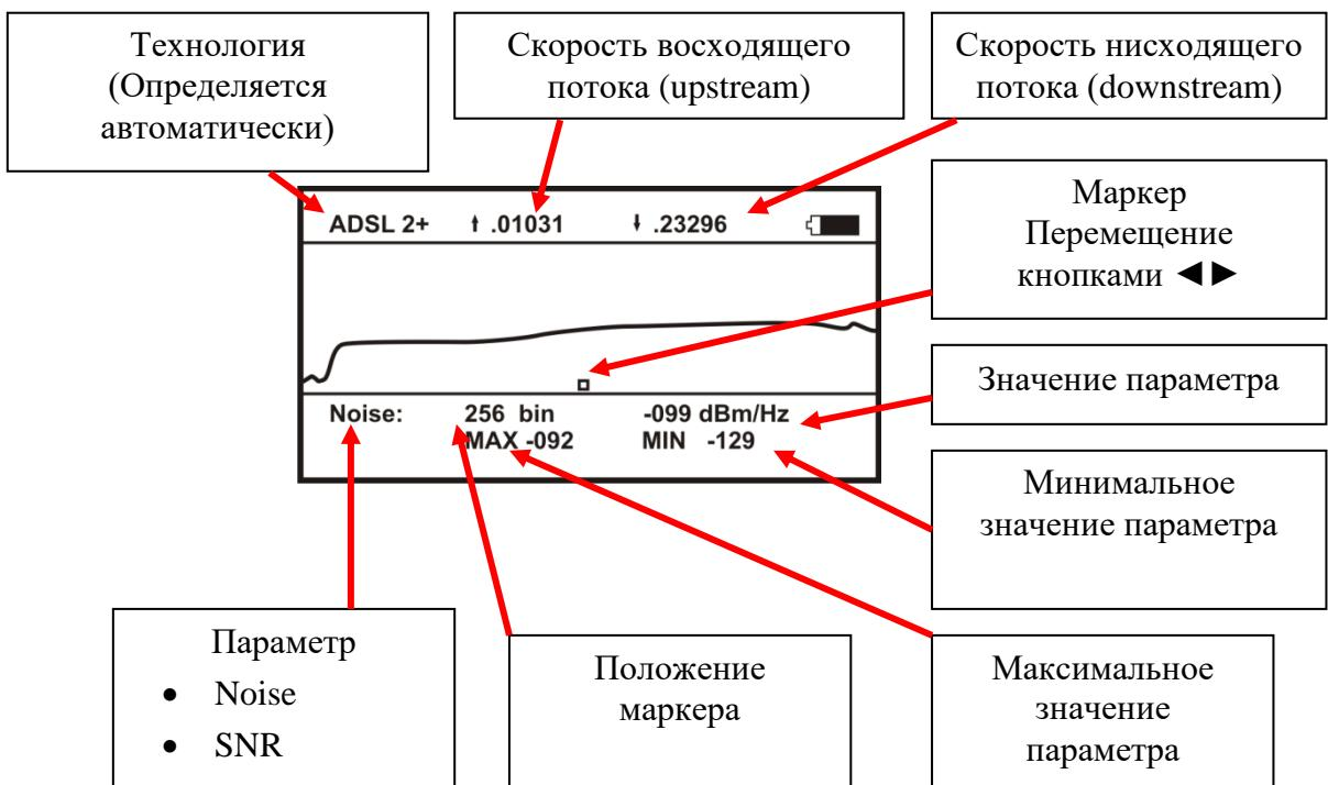
Результаты измерения могут быть сохранены в памяти прибора через Меню2. Можно сохранить до 50 протоколов измерения. Работа с ними полностью аналогична работе с БД кабелей и описана в соответствующем месте руководства.
