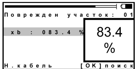
Измерительный провод С отсоедините от вспомогательной жилы и подсоедините к экрану кабеля. Нажмите кнопку [OK]. Прибор покажет расстояние до повреждения неисправного кабеля в процентах длины для неизвестного кабеля или в метрах, если длина введена.
